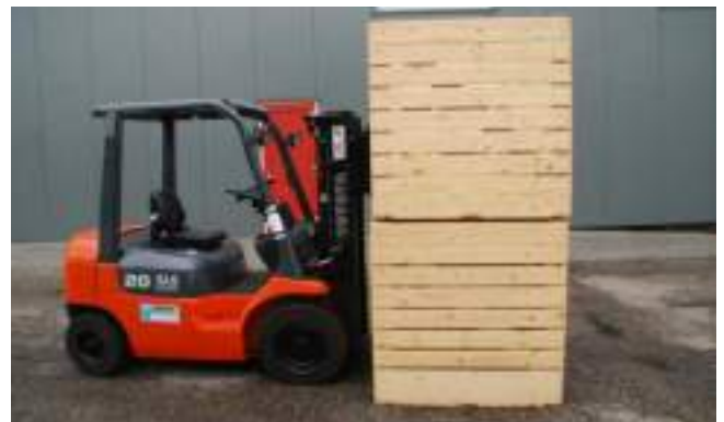
Stap 4 Voorzichtig naar voren rijden en de lading neerzetten.
